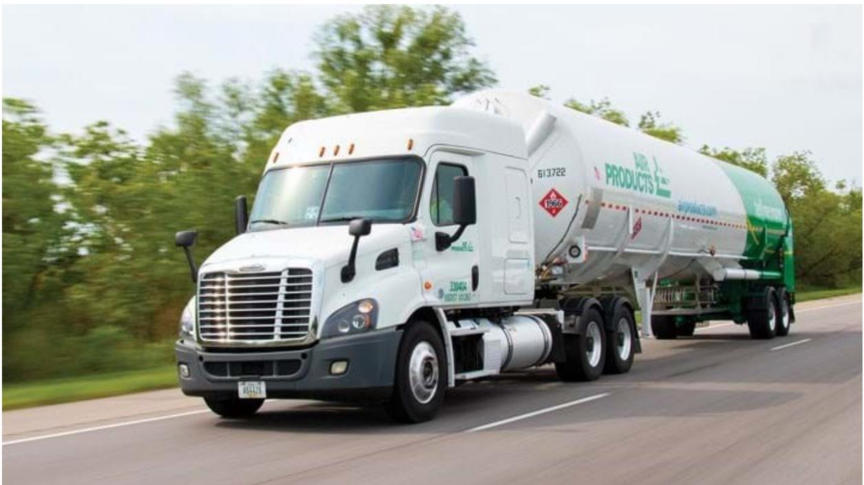
Figura 2: Camión de transporte de hidrógeno líquido marca Air Products
